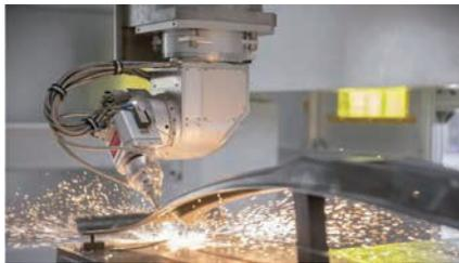
三维五轴激光切割机一直是激光切割装备中的高端产品, 而汽车热成形件三维五轴激光切割机更是此领域的珠穆朗玛峰。
