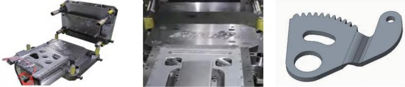
精冲模具是一种精密的冲压加工工艺，它能够在一次冲压行程中获得比传统冲压更高精度的零件。精冲技术的发展始于20世纪60年代的德国，随后在全球范围内得到了广泛应用。精冲技术以其高精度、高效率、高可靠性的特点，在多个行业中有着重要的应用，尤其是在汽车、电子、医疗器械、航空航天等领域。
