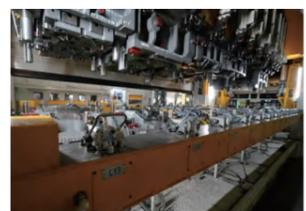
双臂机械手采用 X、Y、Z 轴的典型结构，有 Transfer 和 Feeder 两种运行方式，可循环完成夹紧、抬起、进给、落下、松开、退回等动作，实现对板料的快速搬运。热成型双臂机械手的特点：速度快、负载大、柔性高、适用板料尺寸广；刚性高、输送距离长、定位准确、输送平稳；操作简单、维护方便、故障率低。
