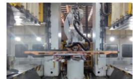
采用笛卡尔坐标系定位方式，通过直线传动模块实现夹紧-松开、举升-下降、移送-回退3个动作；采用气动快换装置，伺服电机驱动，阶跃响应速度快，重复定位误差小。线首拆垛单元由上料台车，磁力分张装置，拆垛机械手，皮带输送和对中机构组成。线中送料单元为三坐标机械手，双臂多工位伺服送料系统将料片从落料工位/首工位搬运到模具的下一步工位中。冲压后工件依次通过多工位的移送、横杆的搬送，一直到模具的最后一道工序，并放置到出料带上，由人工检查和装箱。
