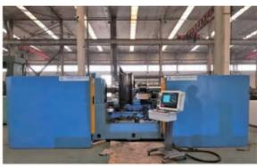
本设备主要用于旋转件的冷旋压成型，可对普碳钢、铝合金、不锈钢等材料进行旋压生产，广泛应用于五金、汽车、风机、军工建筑机械等生产领域。可一次完成旋压、缩口、扩口、修边、车削等工艺。彻底改变拉伸加工中模具费用高、周期长及大深度产品拉伸道次多等缺陷，具有产品升级换代速度快、成本低的特点。
