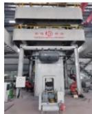
EP系列圆导轨数控电动螺旋压力机分为皮带传动（160T-630T）和齿轮传动（630T-16000T）两种。具有传动链短、结构简单、操作维护方便、运行平稳、噪音低、精度高，力能可随意控制，无下止点，不会出现闷车现象等特点。
