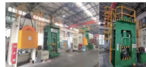
随着国产大飞机自主发展，航空发动机叶片也逐渐走向完全自主化，打破精锻叶片依赖进口直驱设备的壁垒，采购630T和1600T伺服直驱螺旋压力机，用于钛合金、高温合金、铝合金航空零部件的热锻生产。并配套提供了模座及其加热控温系统。
