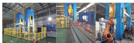
浙江某工程机械锻件生产厂家，采购2台2500吨伺服直驱螺旋压力机作为预锻和终锻设备，3台机器人上下料，配上加热、热剪切、除鳞、锻造、喷石墨、烟气收集、冲孔和打码、热处理等外围设备，实现从整根棒料送进、锻造和后处理一条龙自动化生产，具有集成化、短流程、少飞边等特点，提升了生产效率和锻件质量。
