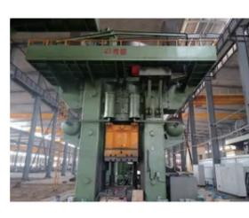
FCP-16000型160MN重型数控摩擦螺旋压力机正面视图
