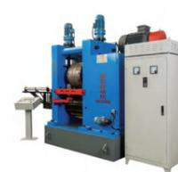
楔横轧是指圆柱形坯料在两轧辊的模具之间发生连续的局部变形，轧制的工件形状与模具底部型槽的形状一致。模具安装在轧辊上，在轧辊带动下向相同方向旋转，使坯料向相反方向旋转，坯料在楔形中径向压缩、变形。产品材料利用率和合格率较高，是实现智能化生产的有效环节。
