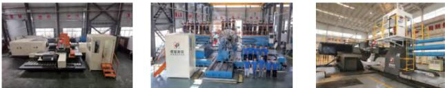
5800卧式双滑台强力数控旋压机是目前国内加工直径最大、推力最强的双滑台强力数控旋压机；完全自主设计、自主制造、自主装配；双滑台位置针对不同形状零件可调，可以独立控制，可以联动。
