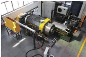
收口旋压机是针对高压气瓶的收口及口部增厚的一款专用设备，带有自动打火加热功能。6061 铝合金气瓶的收口，是采用热旋压的方式，对于温度的控制相当重要。温度低了，管料成型的塑性变化太小，就会挤压破裂，温度过高，材料会烧熔，旋压就会出现掉片的破裂现象。因此温度必须控制在合理的一个范围内。旋压轮的选用非常重要，需要采用大圆角半径的轮子，圆角小了就会把材料拉长，达不到增厚效果。其旋压工艺的设计，不能当作普通的收口旋压工艺来处理，由于技术保密原因，在此不做描述。气瓶的小口直段旋压要做长一些，因为成型后壁厚最大处在直段中间部分。
