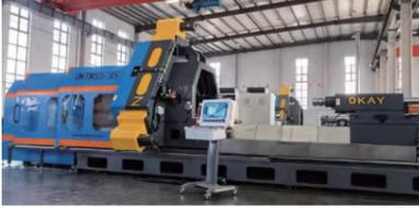
近几年来，针对气瓶行业的市场需求，本公司设计研发出两款适合生产加工气瓶的旋压设备，分别是三轮卧式强力旋压机和收口旋压机，三轮强力旋压机用于毛坯制管，收口机用于气瓶收口。三旋轮卧式强力旋压机是针对不同直径的工件，管类、桶类或小锥类零件的强力变薄旋压而专门设计制造的数控金属旋压机。可以实现正旋，反旋，变径旋，台阶旋等多种旋压工艺方式。设备具有高强度，高精度，高稳定性的特点，可大批量生产或进行特殊试制任务。
