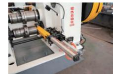
辊锻是回转锻造的一种，属于回旋压缩成型类的范畴。上下辊同步反向旋转，带动扇形模具向内咬合，通过多道次型腔挤压使毛坯成型。辊锻的扇形模具为工作部分，锻锤为承载部分，通过改变模具型腔可以辊锻出不同的工件。辊锻机可辊锻周期断面及各种几何形状断面的零件，机器工作效率高，能够有效降低材料和人工成本，节约能源，适合连续生产。
