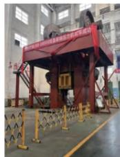
J53系列双盘摩擦压力机（160T-18000T）适用于有色金属和黑色金属的模锻、挤压、切边、弯曲、校正及耐火材料等制品的压制成型工作。台面大，成本低。
