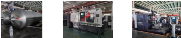
适用于铝合金气瓶管口的旋压收口，旋压收口最大管径 $\Phi 800$
